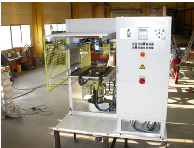
Stand-alone desprue machine (semi-auto)
