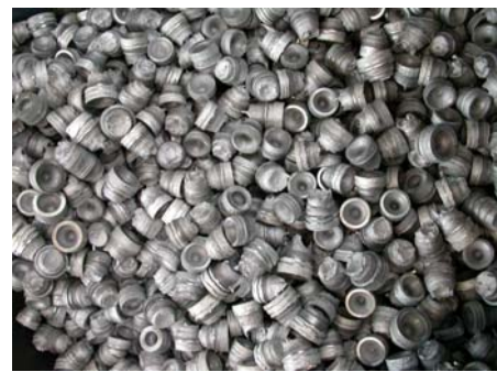
沖出後的澆口件(回爐)
